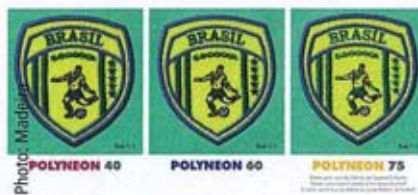
Polyneon der Stärke 40, 60 und 75: Deutlich erkennbar wie unterschiedliche Garnstärken sich auf die Detailtreue auswirken
